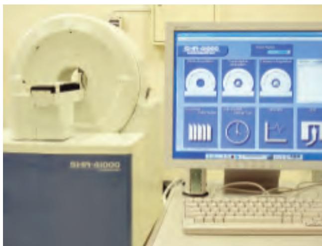
小動物用ポジトロンCT（PET）装置 マウス、ラット等を用いたPETイメージング研究の強力なツール
